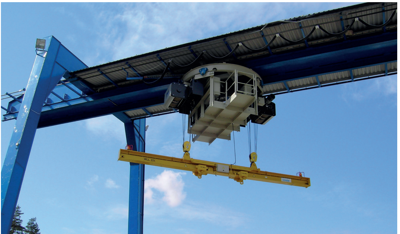
Traverse mit verstellbaren Hebepunkten unter Last
