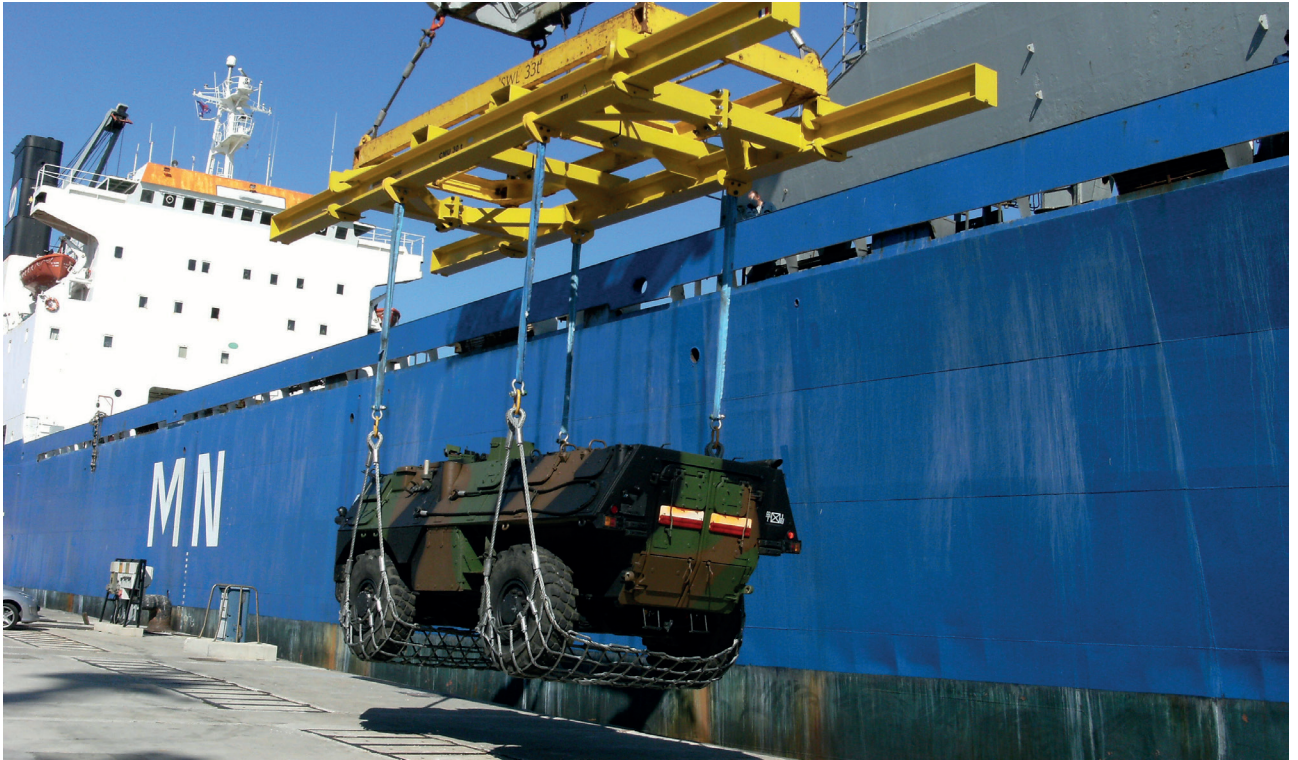
Traverse mit verstellbaren Hebepunkten unter Last
