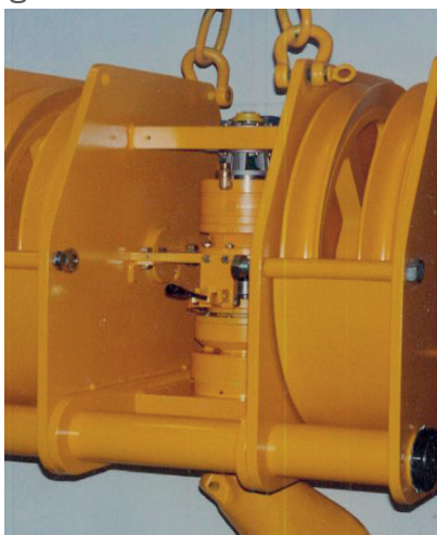
Mechanische Entkopplung (Handgriff) für freie Drehungen
